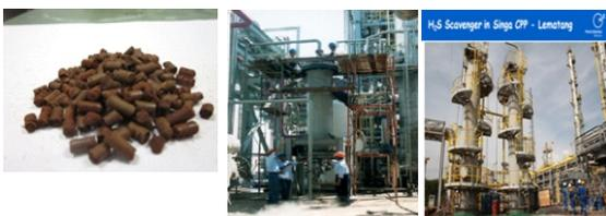
Gambar adsorbent PIMIT-B1 (kiri), Unit demonstrasi pengujian adsorbent (tengah) di Aceh dan unit pemakai adsorbent di PT Medco Energi Lematang (kanan)
