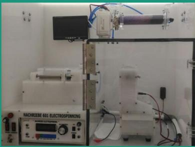
Electrospinning adalah salah satu teknik fabrikasi serat berskala nanometer dengan memanfaatkan medan elektrostatis. Beberapa parameter yang memengaruhi proses pemintalan, antara lain: parameter lingkungan, parameter fisis sintesis, dan larutan polimer. Pemilihan parameter yang tepat akan memengaruhi nanomaterial yang dihasilkan sesuai dengan aplikasinya.
